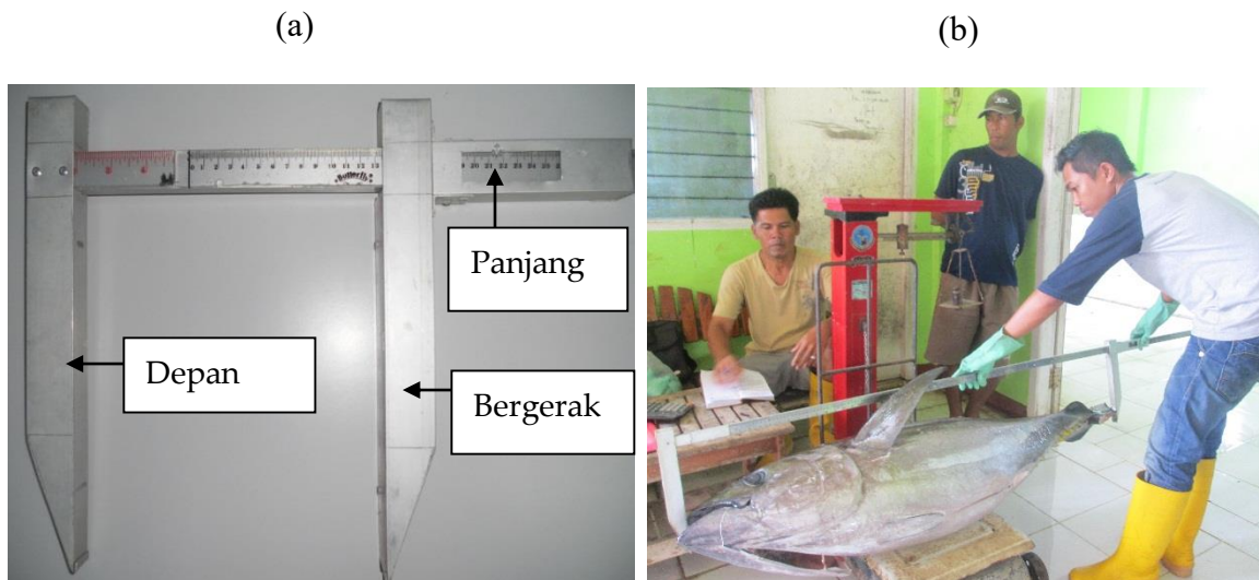
Gambar 5: Kaliper. (a) Pengukuran dibaca dari panah kecil yang tebal. Lengan depan dan bergerak dari kaliper ditandai dan (b) demonstrasi penggunaan kaliper. (© MPDI)
